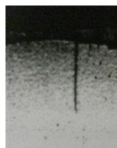
Рисунок 8.9 - Поверхность титана с треками внедрённых частиц карбида титана (x400)
