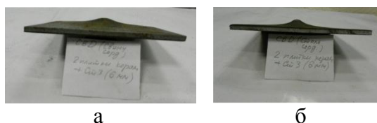
Рисунок 2.7 - Тыльный лист Ст.3 после испытаний элементной брони на пулестойкость против пули со свинцовым – а и стальным – б сердечником патрона 57-Н-323С винтовки СВД
