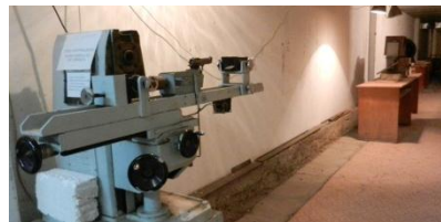
Рисунок 3.4 - Установка испытания на пулестойкость бронеконструкций в испытательной лаборатории СамГТУ
