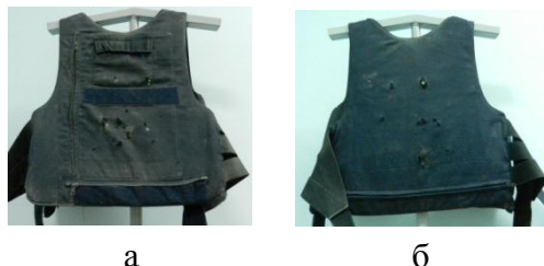
Рисунок 3.7 - Бронежилет 1-го класса защиты из баллистической ткани кевлар, а – лицевая и б – внутренняя стороны после выстрелов из пистолета Макарова ПМ
