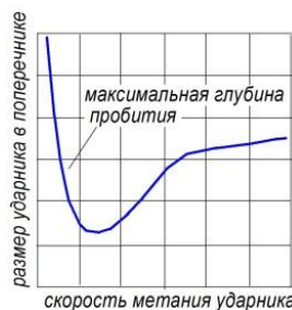
Рисунок 7.7 - Зависимость максимальной глубины пробития от диаметра ударника
