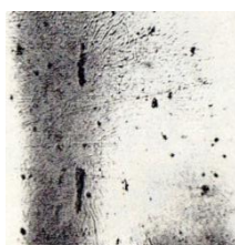
Рисунок 8.8 - Треки внедрённых частиц вольфрама в стали (x700)
