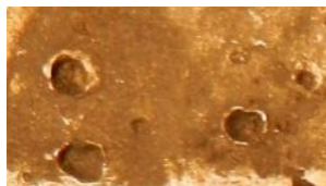
Рисунок 8.2 - Неглубокие кратеры размером ~2 мм
