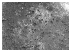
Рисунок 8.4 - Поверхность образца технического железа, обработанного потоком частиц диборида титана, разогнанных энергией взрыва канальных зарядов ВВ
