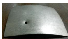
Рисунок 3.8 - Результат испытаний алюминиевых броневставок и пакета баллистической ткани 1-го класса защиты выстрелом из пистолета Макарова ПМ пулями ПСТ
