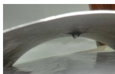
Рисунок 3.21 - Тыльная пластина опытного образца после выстрела из пистолета «Викинг»
