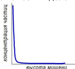
Рисунок 8.10 - Общий характер распределения внедрённых частиц в преграде при СГП
