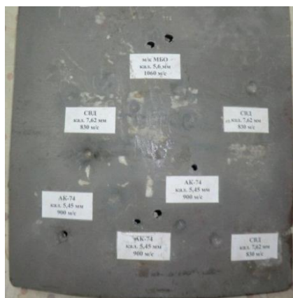
Рисунок 1.2 - Бронепластина с результатами выстрелов из стрелкового оружия АК-74, СВД, м/к МБО
