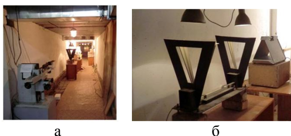
Рисунок 1.4 - Исследовательская лаборатория испытаний бронеконструкций с использованием установки крепления оружия - а и измерением скорости пули по хронографу «COMPETITIVE EDGE DYNAMICS (CED) Millennium» - б
