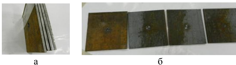
Рисунок 2.4 - Исследование пулестойкости стали Ст.3 выстрелом из винтовки СВД пулей ЛПС винтовочного патрона 57-Н-323С, вид сборки (4х6 мм) – а и послойно – б.
