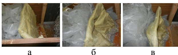
Рисунок 3.11 - Торможение свинцовой пули винтовочного патрона 7.62x54 мм в пакете кевлара, последовательные кадры от начала торможения – а, б, и конец торможения – в
