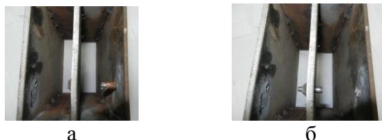
Рисунок 1.9 - Испытания разнесённой трёхслойной бронеконструкции из листов стали Ст.3 по 5 классу пулестойкости, а – пробитие пуль фронтальной пластины, б – пробитие пуль средней пластины
