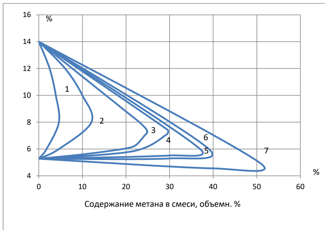
Рис.5.3. Зависимость концентрационного предела распространения пламени от содержания флегматизатора в смеси.
