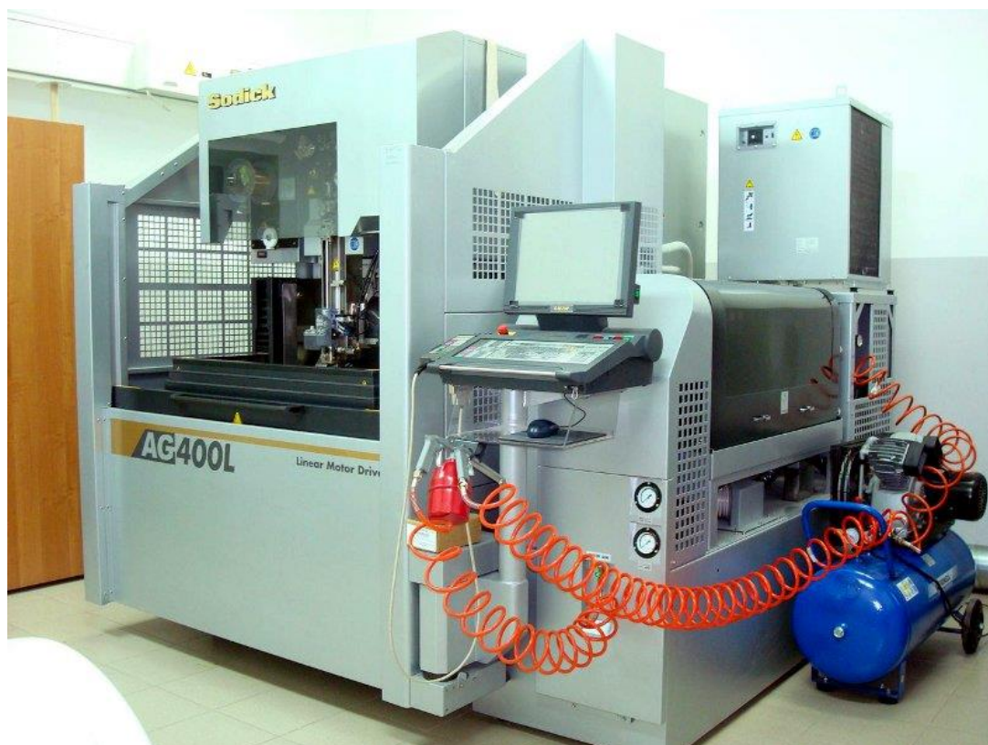
Рисунок 2.9 – Электроэрозионный станок с ЧПУ Sodick AG400L LN2W
