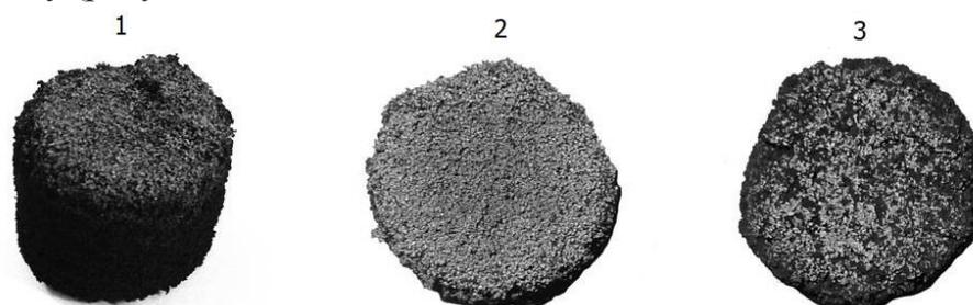
Рис. 6. Продукты реакции: 1) общий вид продукта; 2) сечение продукта при 25 % ( $\text{Fe}_2\text{O}_3+3\text{C}$ ) в исходной шихте; 3) сечение продукта при 40 % ( $\text{Fe}_2\text{O}_3+3\text{C}$ ) в исходной шихте
