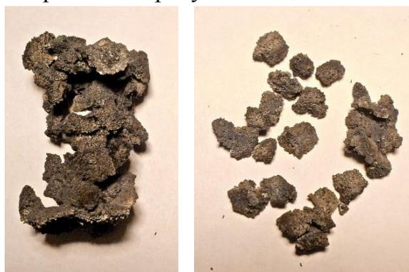
Рис. 3. Продукт реакции при содержании термитных гранул в шихте 50 % - до разделения (слева) и после разделения (справа)
